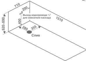
Монтажная схема установки ванны
