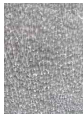
Образец стекла с «правильной закалкой»
