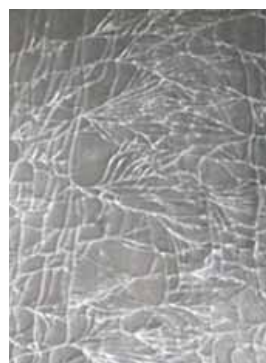
Образец стекла с нарушением технологического процесса
