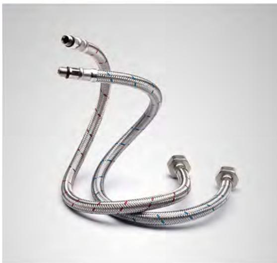
В состав шлангов входят: проволоки из оцинкованной стали и оплетка из нержавеющей стали марки «AISI 304», фурнитура(гайки, резьбовые соединения) изготовлены из сантехнической латуни, внутренние шланги из нетоксичной резины «EPDM». Материалы полностью соответствуют международным стандартам, что подтверждено испытаниями шлангов на разрыв под давлением 2.5 МПа, и испытание крутящим моментом крепежной гайки усилием в 60 и.м
