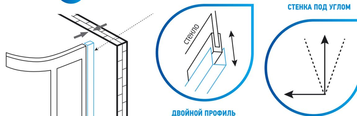
**В ДУШЕВЫХ УГОЛКАХ ERLIT ИСПОЛЬЗУЕТСЯ ДВУХПРОФИЛЬНАЯ СИСТЕМА КРЕПЛЕНИЯ КАРКАСА К СТЕНЕ, КОТОРАЯ ПОЗВОЛЯЕТ УСТАНАВЛИВАТЬ ДУШЕВЫЕ УГОЛКИ ERLIT В ПОМЕЩЕНИЯХ С «ЗАВАЛЕННЫМИ СТЕНАМИ»,**
