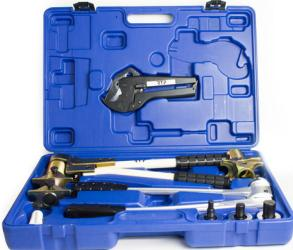
Состав набора для монтажа трубы PE-Ха и аксиальных фитингов:
